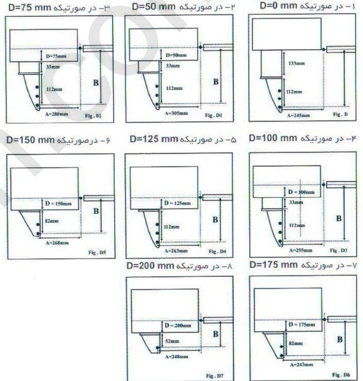
توجه: لازم به ذکر است برای جک مدل FARAZ 5M/P این رابطه در صورتیکه  $D > 0$  باشد برقرار است:  $A + B = 500$
