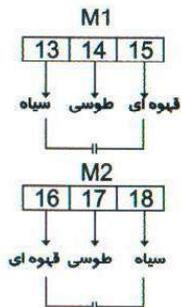
**موتور راست (M2):** اگر موتور را به گونه ای قرار دهید که برآمدگی موتور جک رو به پایین و بازوی جک به طرف راست باز شود این موتور موتور راست نامیده می شود که سیم بندی آن به ترمینالها مطابق شکل زیر است .
