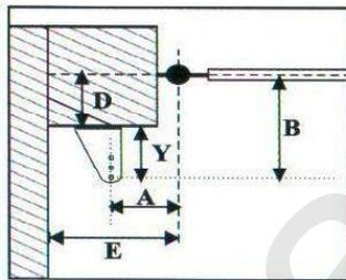
۵- مطابق قسمت B شکل قسمت یک STOPهایی از یک وسیله محکم جهت ثابت نگه داشتن، در ابتدا و انتهای زاویه چرخش درب بر روی زمین یا چارچوب باید تعبیه گردد. چنانچه مدت زمان باز و بسته شدن درب به هر دلیلی تغییر نماید، STOPها مانع از وارد آمدن فشار مضاعف به درب و یا جک می شود.
